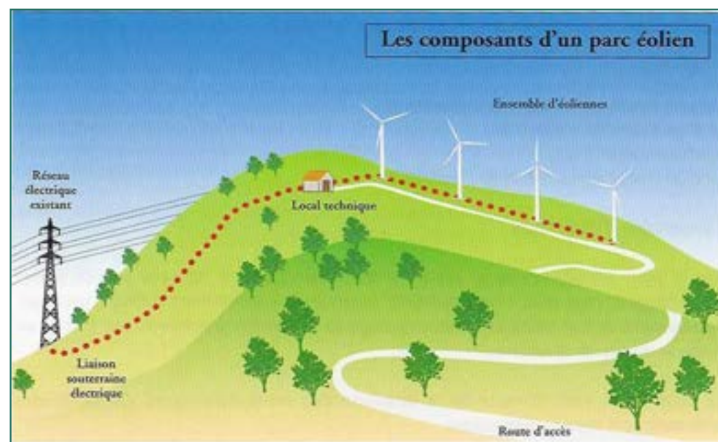
Figure 94 : Les composants d'un parc éolien
