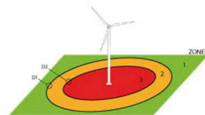
Figure 16 : Distances de sécurité entre une éolienne et un ouvrage de GRT gaz
